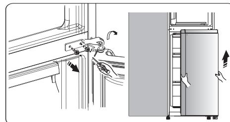
9. Aseta alaovi tasaiselle alustalle paneeli ylöspäin. Löysää ruuvi 3 ja irrota osa 2 ja osa 1. Asenna toimitettu (muovipussissa) oven vaihtopysäytin-vasen 4 ja osa 2 (pysäytyspala) vasemmalle puolelle ruuvilla 3. Säilytä osa 1 laitteen mukana tulevaa käyttöä varten.
