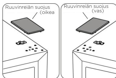
6. Poista osa 1 yläsuojuksen vasemmasta yläkulmasta. Poista sitten osa 3 yläsuojuksen oikeasta yläkulmasta. Asenna osa 1 yläsuojukseen oikeaan yläkulmaan.
