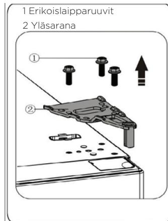
4. Irrota yläovi keskisanasta nostamalla ovi varovasti suoraan ylös. Aseta sitten yläovi tasaiselle alustalle yläkansi ylöspäin.
