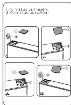
7. Löysää ruuvi 3 ja poista osa 2 ja osa 1. Asenna toimitettu (muovipussissa) oven vaihtopysäytin-vasen 4 ja osa 2 (pysäytyspala) vasemmalle puolelle ruuvilla 3. Säilytä osa 1 laitteen mukana tulevaa käyttöä varten.
