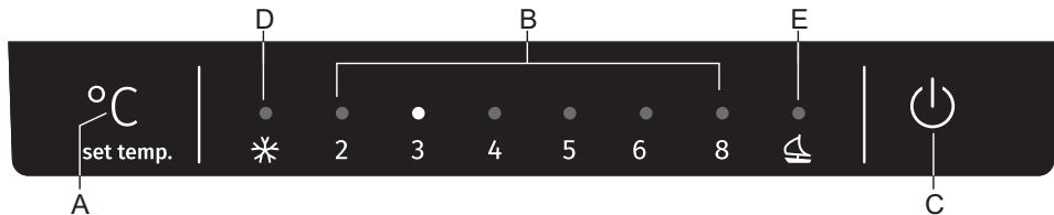
**A** Lämpötilan säätö- ja tilanvalintapainike
